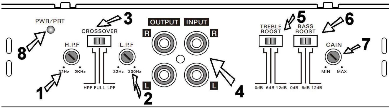
**1.H.P.F High pass Filter**- Регулиране на високите честоти при режим на възпроизвеждане на високи честоти.
